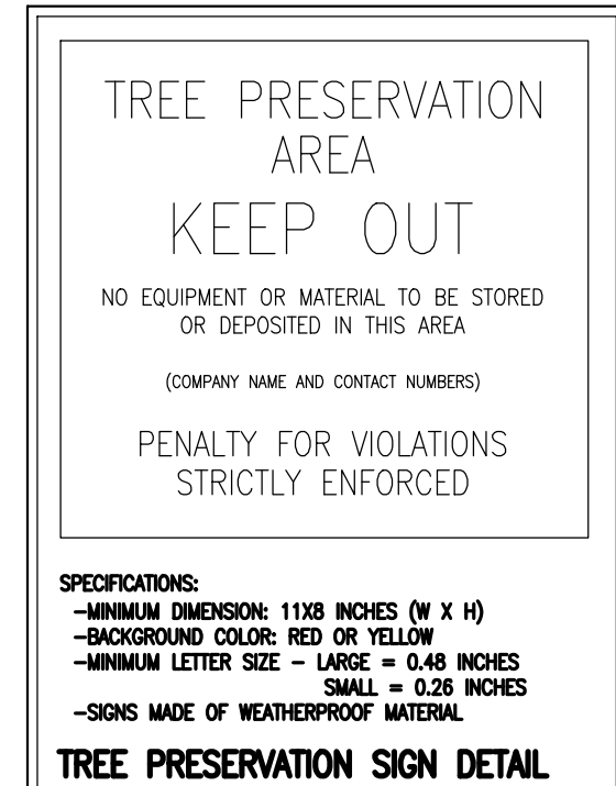
2 TREE PROTECTION DEVICES N.T.S.
