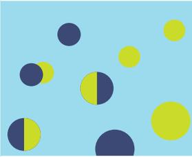
Después de extraer el agua del río o el lago, se agrega una sustancia para que las partículas se unan entre sí en el líquido.
